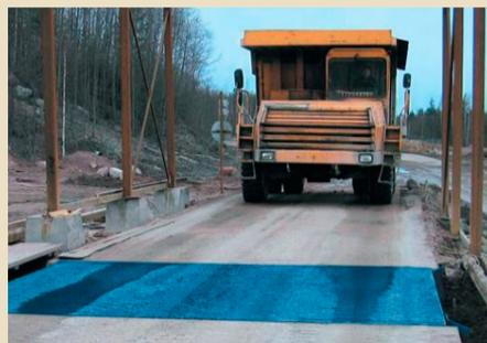
Рис. 1. Взвешивание большегрузных автомобилей в движении на весах «ВА-Д»
