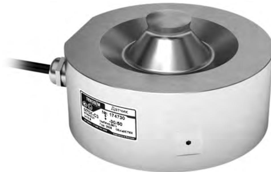
**Тензодатчики сжатия мембранного типа из нержавеющей стали. Диапазон нагрузок от 10 до 30т. Степень защиты оболочкой IP68**
